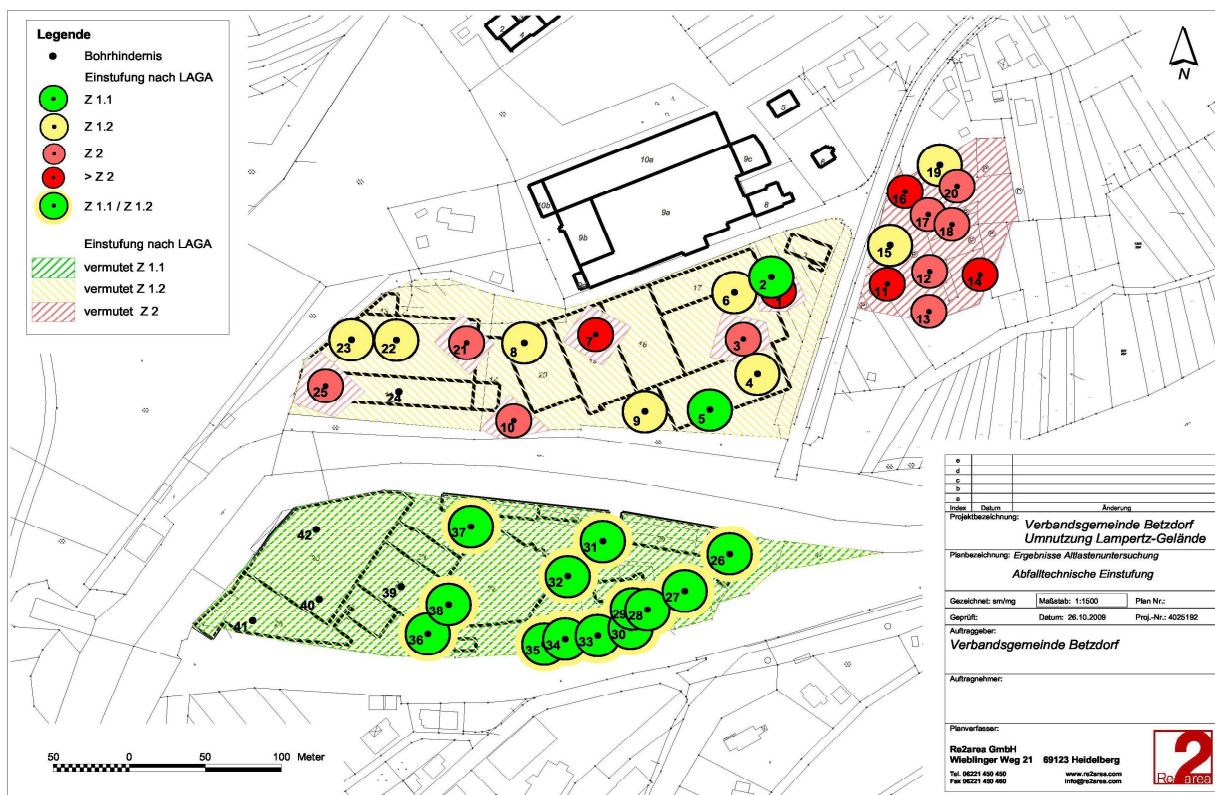
Abbildung 3 Abfalltechnische Einstufung der untersuchten Bereiche
