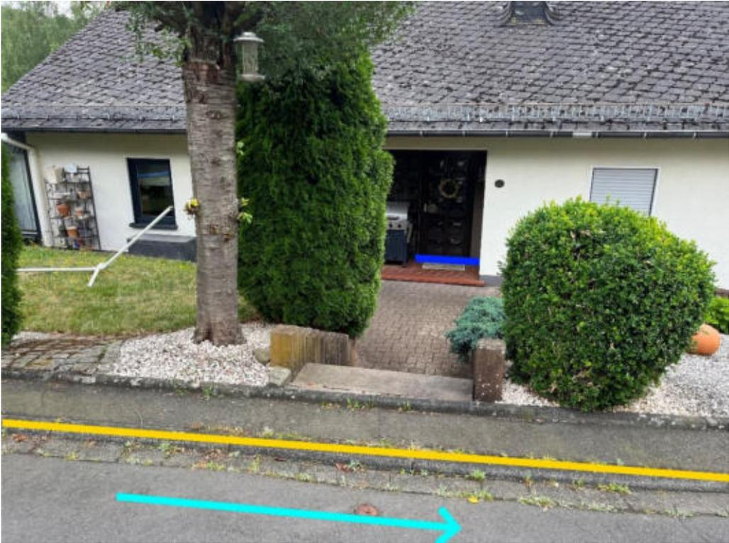
Abbildung 71: Notabflussweg " Dellstraße " mit Fließweg (hellblau), Objektschutzmaßnahmen (blau) und Bordanlagen (gelb)
