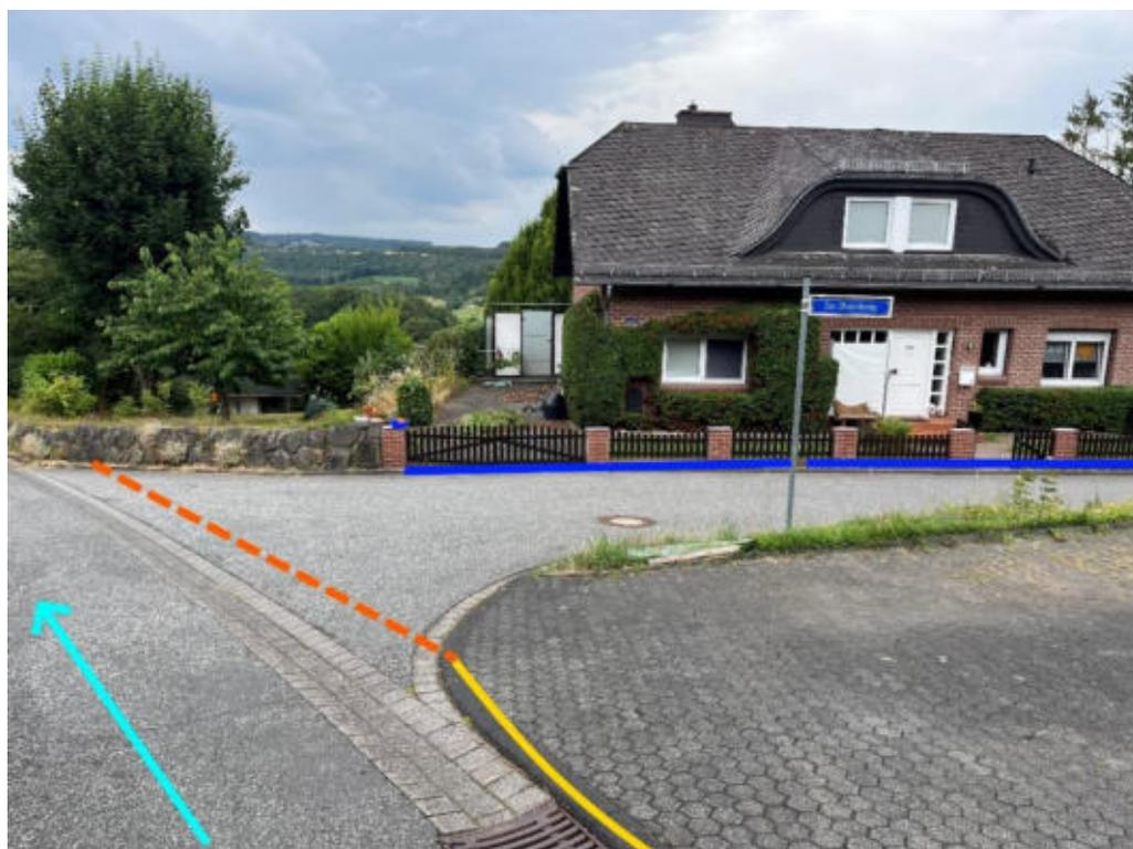
Abbildung 98: Notabflussweg "Ginsterfeldestraße" mit Fließweg (hellblau), Objektschutzmaßnahmen (blau), Aufwallung (orange) und Bordanlagen (gelb)
