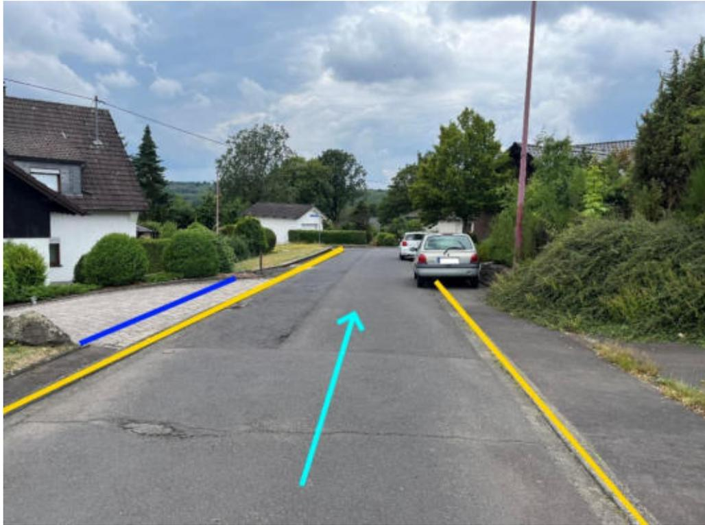
Abbildung 79: Notabflussweg " Dellstraße " mit Fließweg (hellblau), Objektschutzmaßnahmen (blau) und Bordanlagen (gelb)
