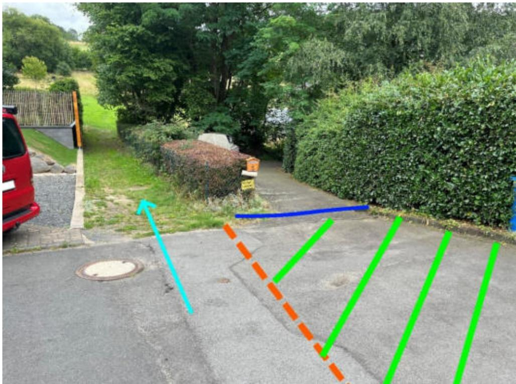
Abbildung 90: Notabflussweg "Zum Antenborn" mit Fließweg (hellblau), Objektschutzmaßnahmen (blau), Aufwallung (orange) und Senke (grün)
