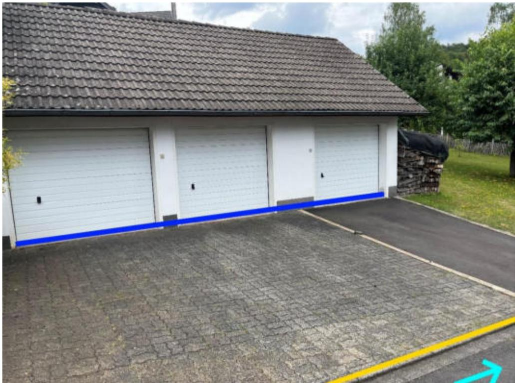
Abbildung 88: Notabflussweg "Zum Antenborn" mit Fließweg (hellblau), Objektschutzmaßnahmen (blau) und Bordanlagen (gelb)
