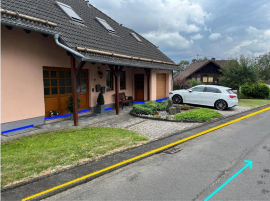
Abbildung 78: Notabflussweg " Dellstraße " mit Objektschutzmaßnahmen (blau), Aufwallung (orange) und Bordanlagen (gelb)
