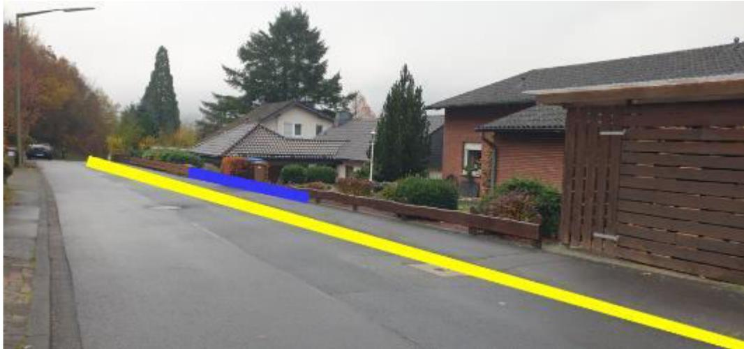
Abbildung 65: Notfließweg südlicher Eisenweg Bordanlagen (gelb) und Objektschutzmaßnahmen (blau)
