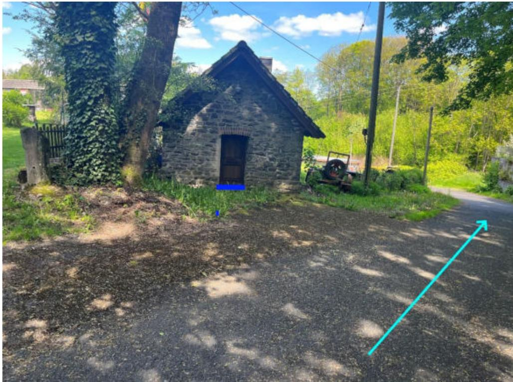
Abbildung 104: Notabflussweg "Ringstraße" mit Fließrichtung (hellblau) und Objektschutzmaßnahmen (dunkelblau)
