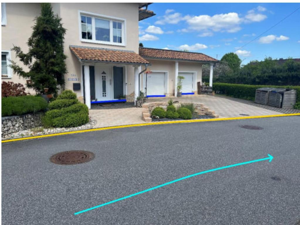
Abbildung 91: Notabflussweg "Ringstraße" mit Fließrichtung (hellblau), Objektschutzmaßnahmen (dunkelblau) und Bordanlagen (gelb)
