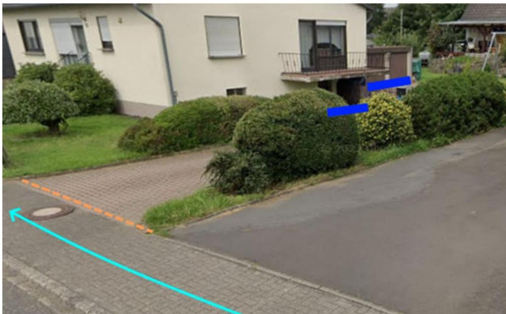
Abbildung 115: Notabflussweg "Marienbergerstraße" mit Fließrichtung (hellblau), Objektschutzmaßnahmen (dunkelblau) und Aufwallung (orange)
