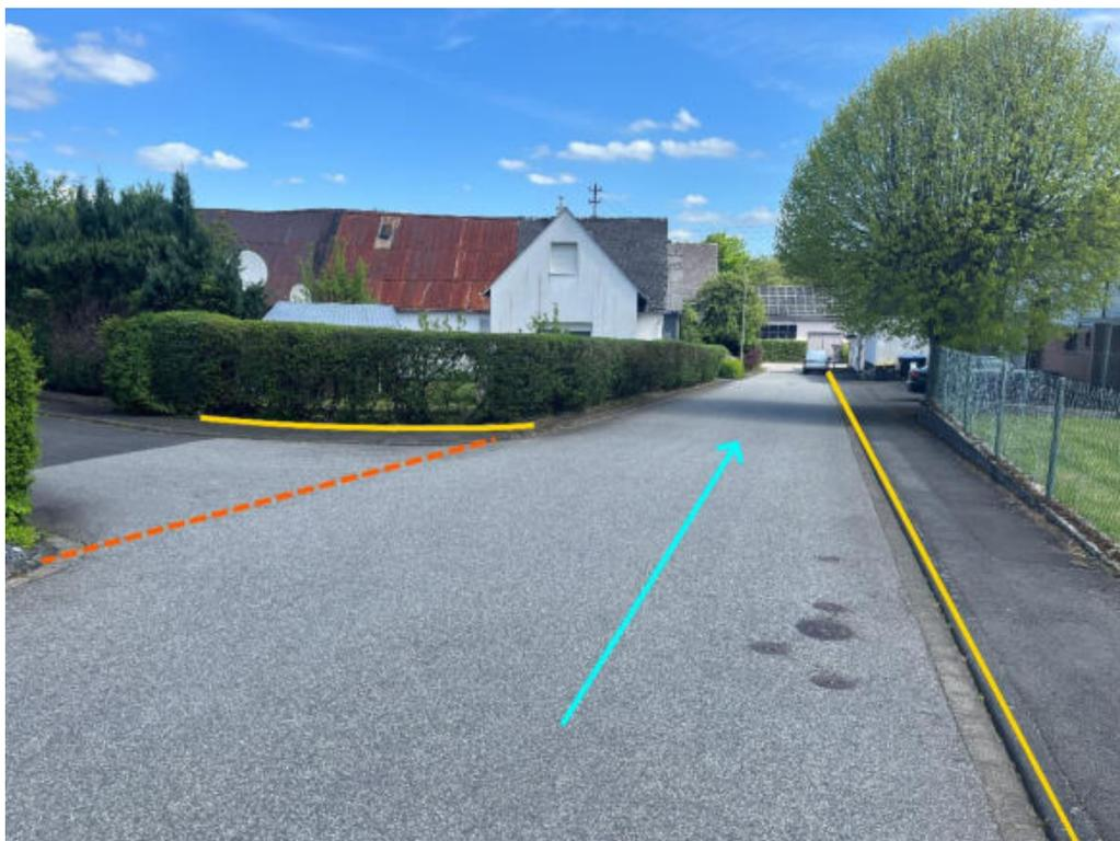
Abbildung 92: Notabflussweg "Ringstraße" mit Fließrichtung (hellblau), Aufwallung (orange) und Bordanlagen (gelb)
