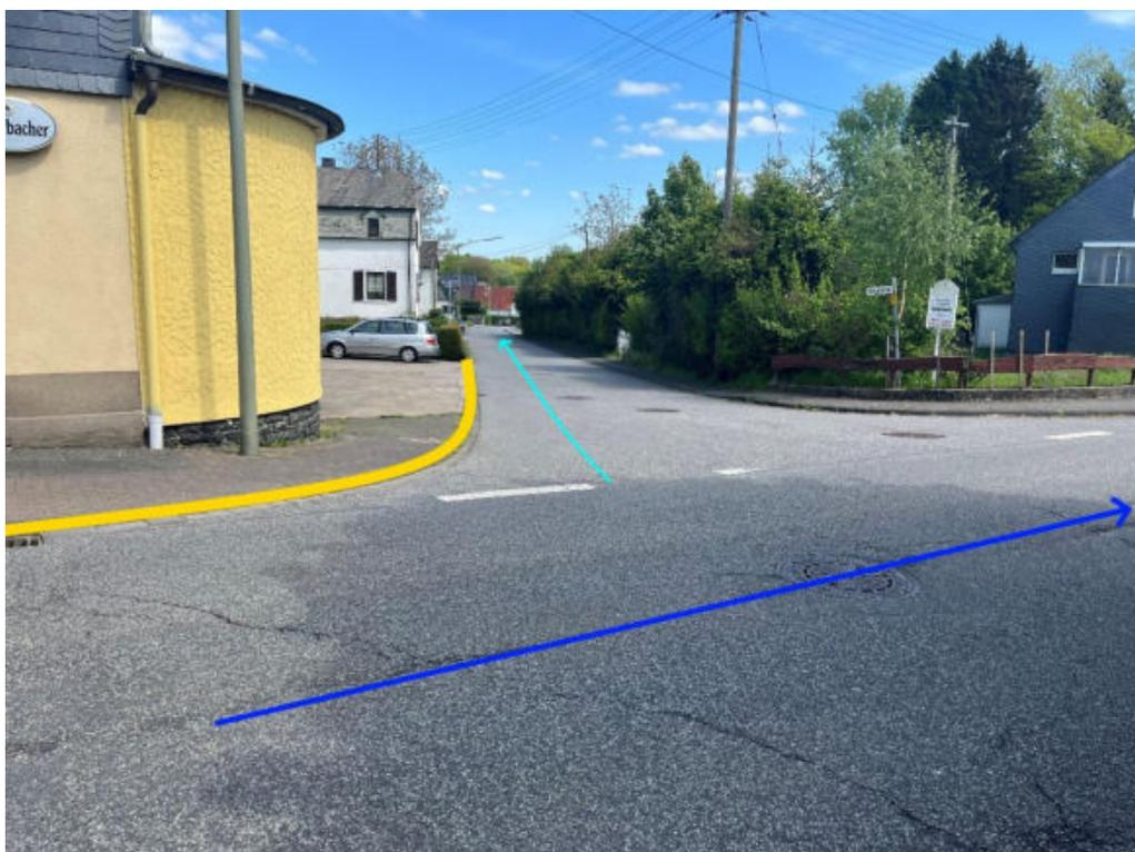
Abbildung 83: Notabflussweg "Ringstraße" mit Fließrichtung (hellblau), Objektschutzmaßnahmen (dunkelblau) und Bordanlagen (gelb)
