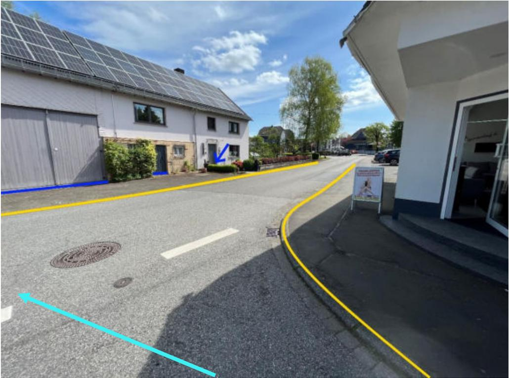
Abbildung 98: Notabflussweg "Ringstraße" mit Fließrichtung (hellblau), Objektschutzmaßnahmen (dunkelblau) und Bordanlagen (gelb)
