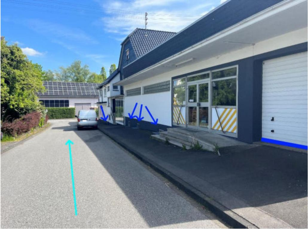
Abbildung 95: Notabflussweg "Ringstraße" mit Fließrichtung (hellblau) und Objektschutzmaßnahmen (dunkelblau)
