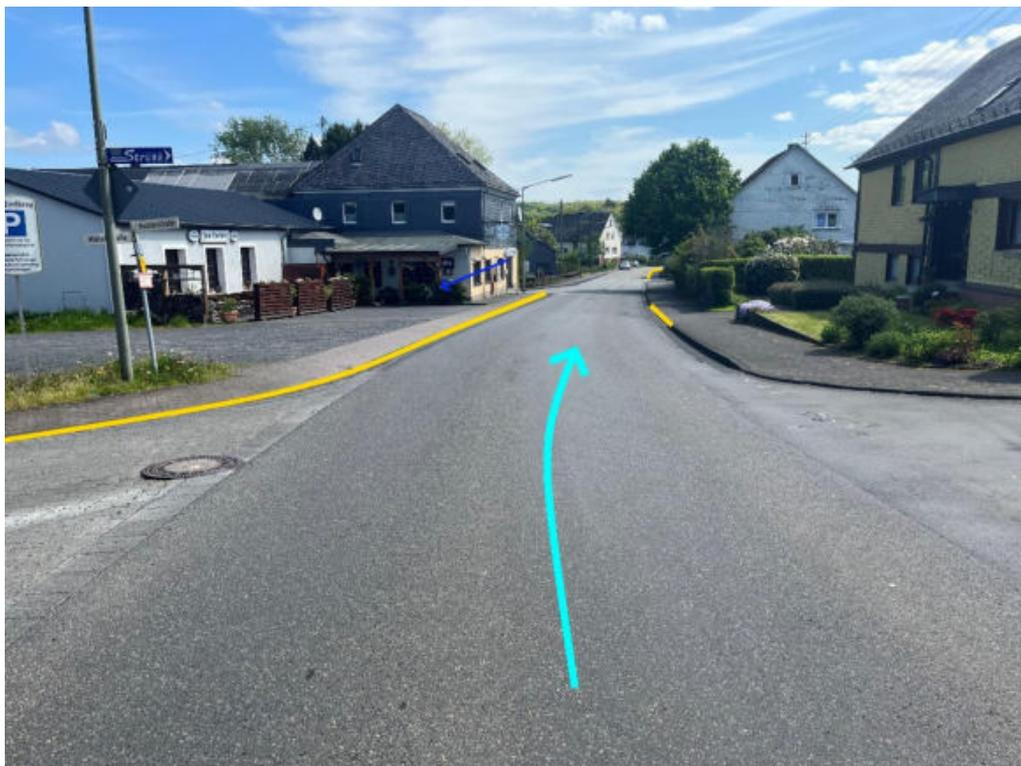
Abbildung 81: Notabflussweg "Ringstraße" mit Fließrichtung (hellblau), Objektschutzmaßnahmen (dunkelblau) und Bordanlagen (gelb)
