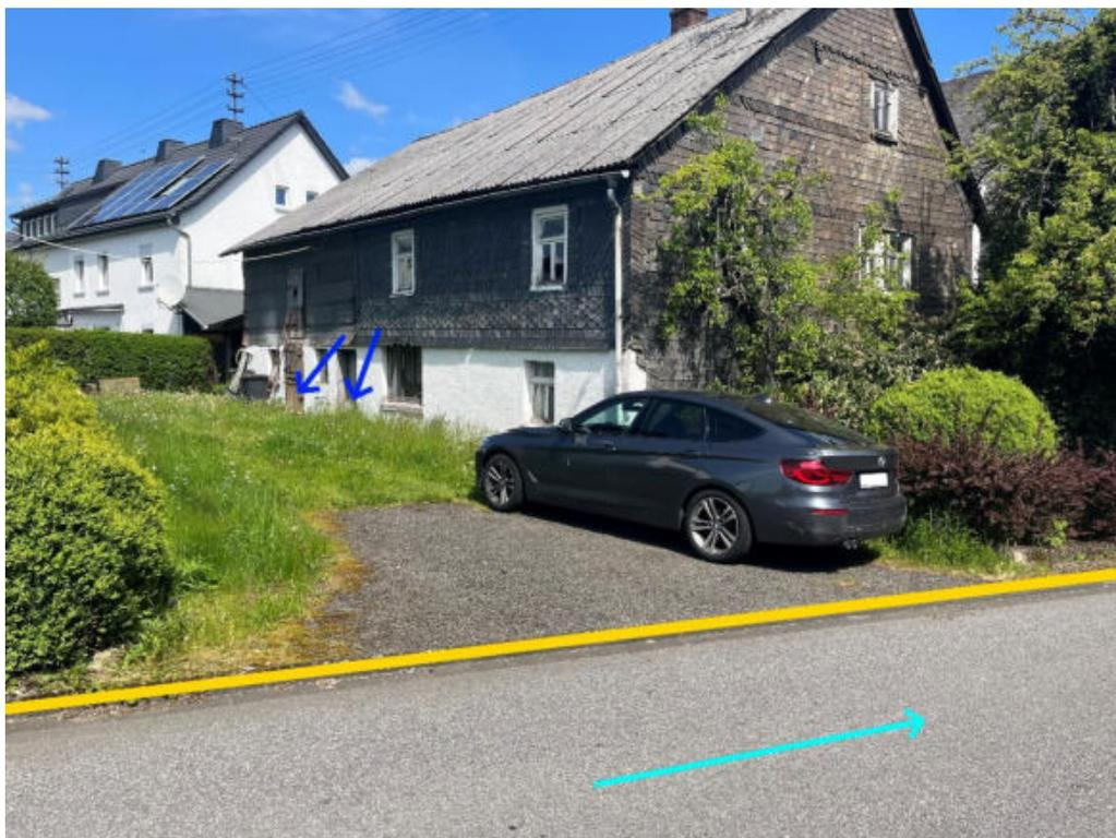
Abbildung 96: Notabflussweg "Ringstraße" mit Fließrichtung (hellblau), Objektschutzmaßnahmen (dunkelblau) und Bordanlagen (gelb)
