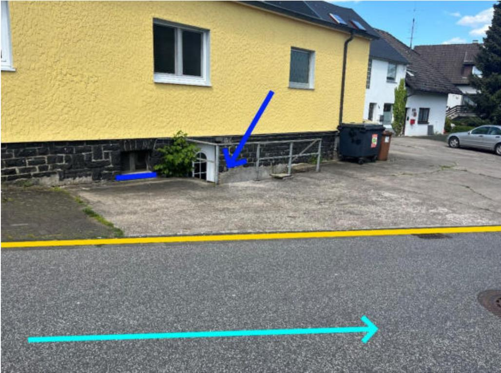
Abbildung 84: Notabflussweg "Ringstraße" mit Fließrichtung (hellblau), Objektschutzmaßnahmen (dunkelblau) und Bordanlagen (gelb)
