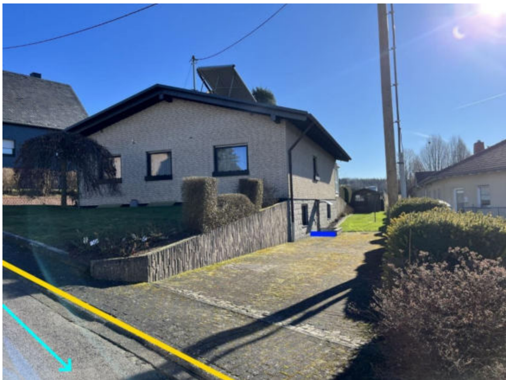
Abbildung 183: Notabflussweg "Bergstraße" mit Fließrichtung (hellblau), Objektschutzmaßnahmen (blau) und Bordanlagen (gelb)
