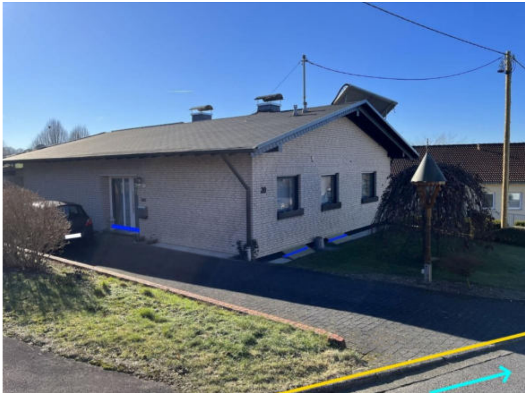
Abbildung 180: Notabflussweg "Bergstraße" mit Fließrichtung (hellblau), Objektschutzmaßnahmen (blau) und Bordanlagen (gelb)
