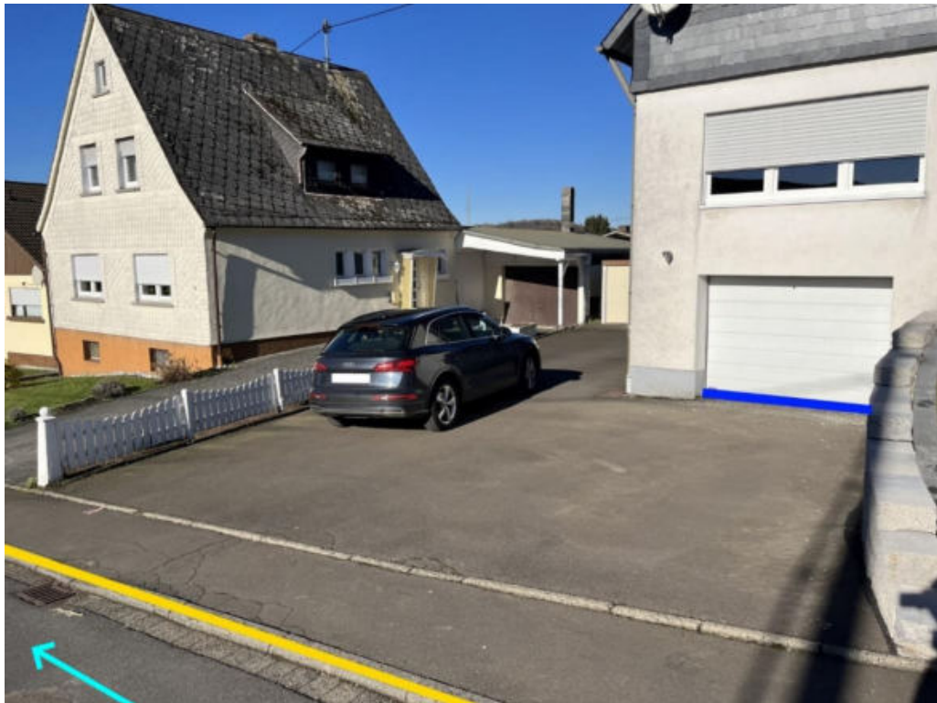
Abbildung 182: Notabflussweg "Bergstraße" mit Fließrichtung (hellblau), Objektschutzmaßnahmen (blau) und Bordanlagen (gelb)
