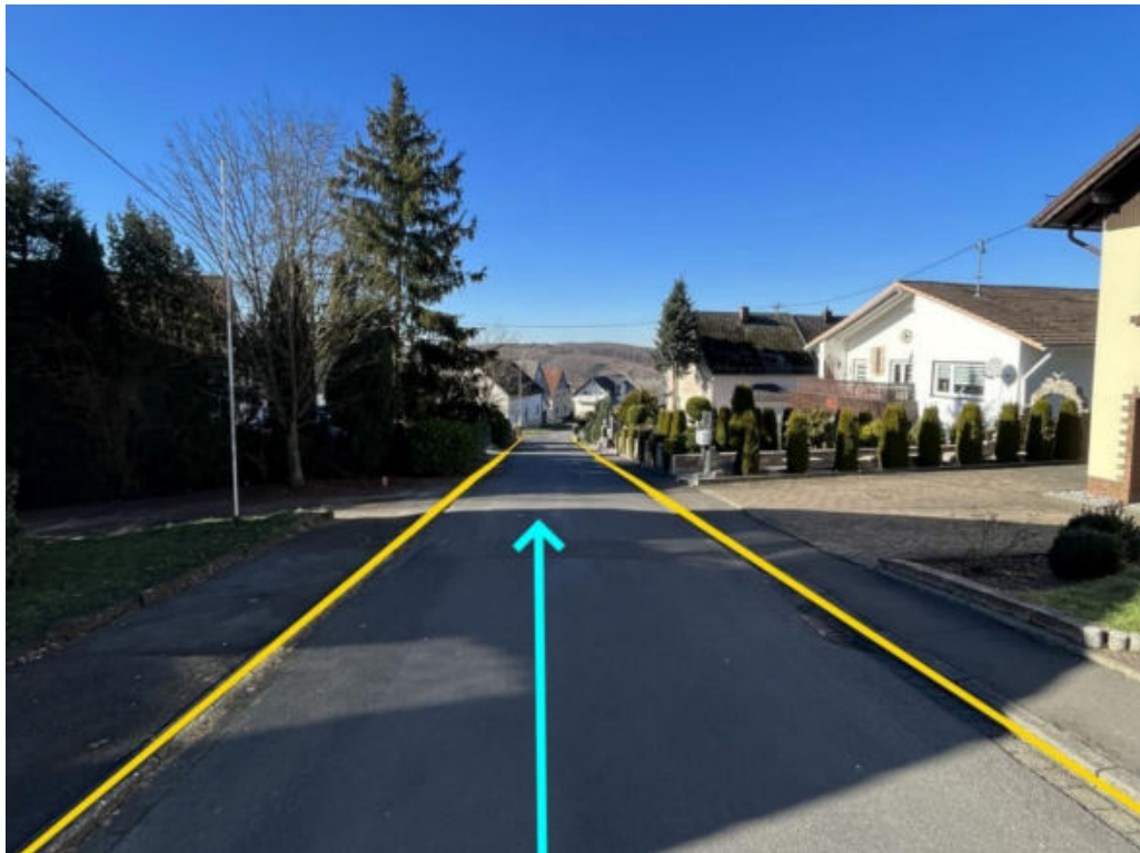
Abbildung 186: Notabflussweg "Bergstraße" mit Fließrichtung (hellblau), Objektschutzmaßnahmen (blau) und Bordanlagen (gelb)
