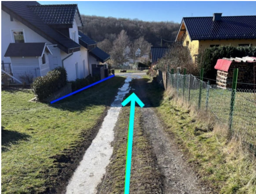
Abbildung 190: Notabflussweg "Bergstraße" mit Fließrichtung (hellblau), Objektschutzmaßnahmen (blau) und Bordanlagen (gelb)
