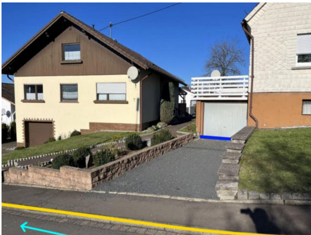
Abbildung 184: Notabflussweg "Bergstraße" mit Fließrichtung (hellblau), Objektschutzmaßnahmen (blau) und Bordanlagen (gelb)
