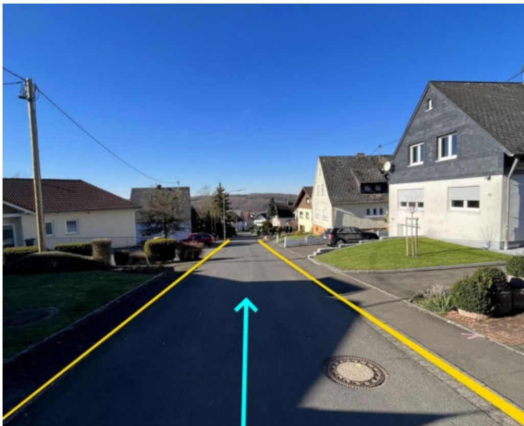
Abbildung 181: Notabflussweg "Bergstraße" mit Fließrichtung (hellblau), Objektschutzmaßnahmen (blau) und Bordanlagen (gelb)
