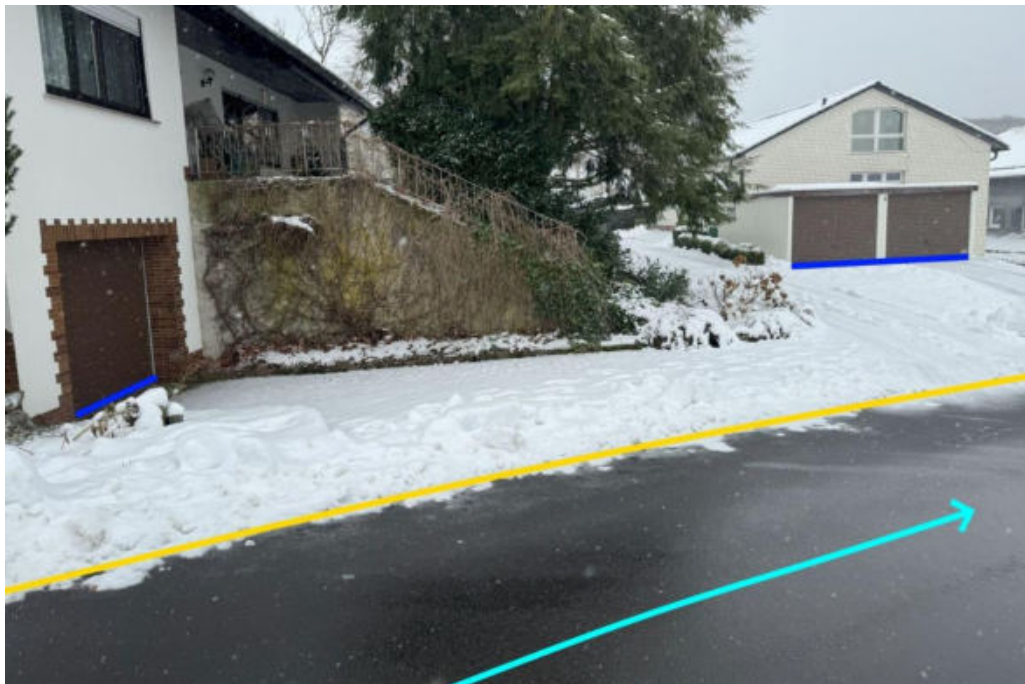
Abbildung 141: Notabflussweg "Rosenweg" mit Fließrichtung (hellblau), Objektschutzmaßnahmen (blau) und Bordanlagen (gelb)
