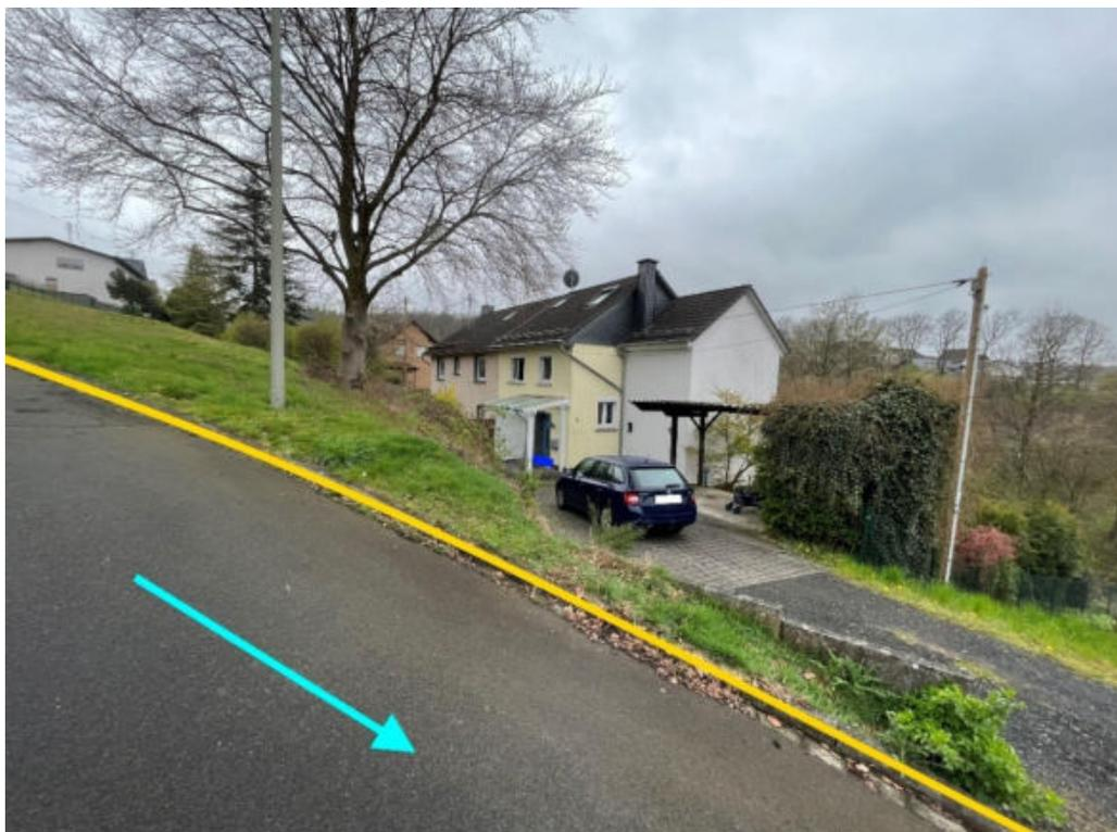
Abbildung 198: Notfließweg „Bergstraße“ mit Fließrichtung (hellblau), Objektschutzmaßnahmen (dunkelblau) und Bordanlagen (gelb)
