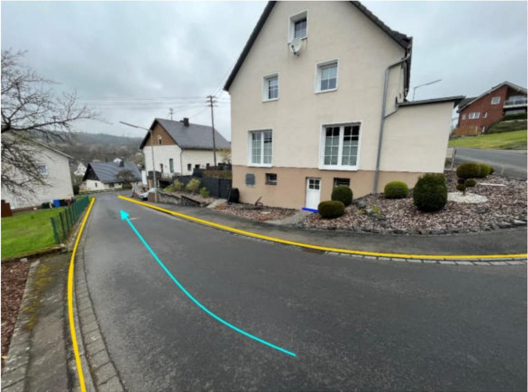
Abbildung 203: Notfließweg „Bergstraße“ mit Fließrichtung (hellblau), Objektschutzmaßnahmen (dunkelblau) und Bordanlagen (gelb)
