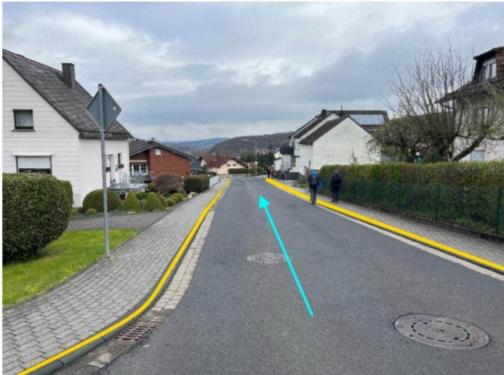
Abbildung 127: Notfließweg „Hahnwallstraße" mit Fließrichtung (hellblau) und Bordanlagen (gelb)
