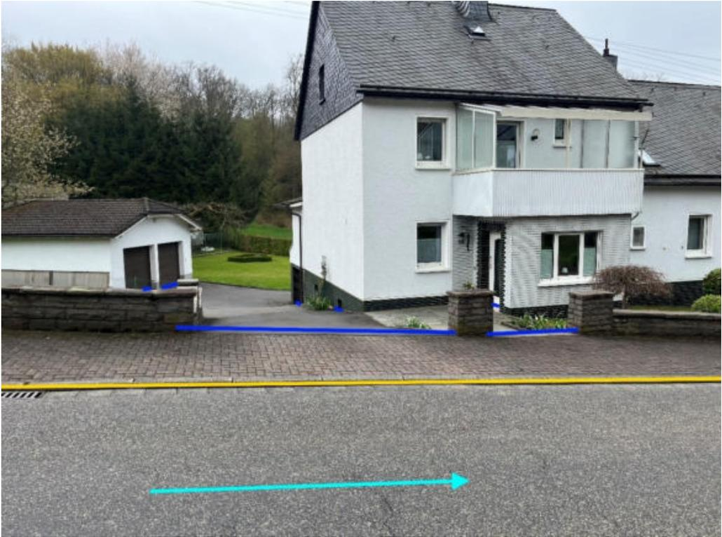
Abbildung 100: Notfließweg „Bindweider Straße“ mit Fließrichtung (hellblau), Objektschutzmaßnahmen (dunkelblau) und Bordanlagen (gelb)
