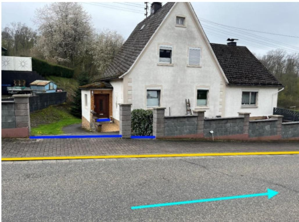
Abbildung 97: Notfließweg „Bindweider Straße“ mit Fließrichtung (hellblau), Objektschutzmaßnahmen (dunkelblau) und Bordanlagen (gelb)
