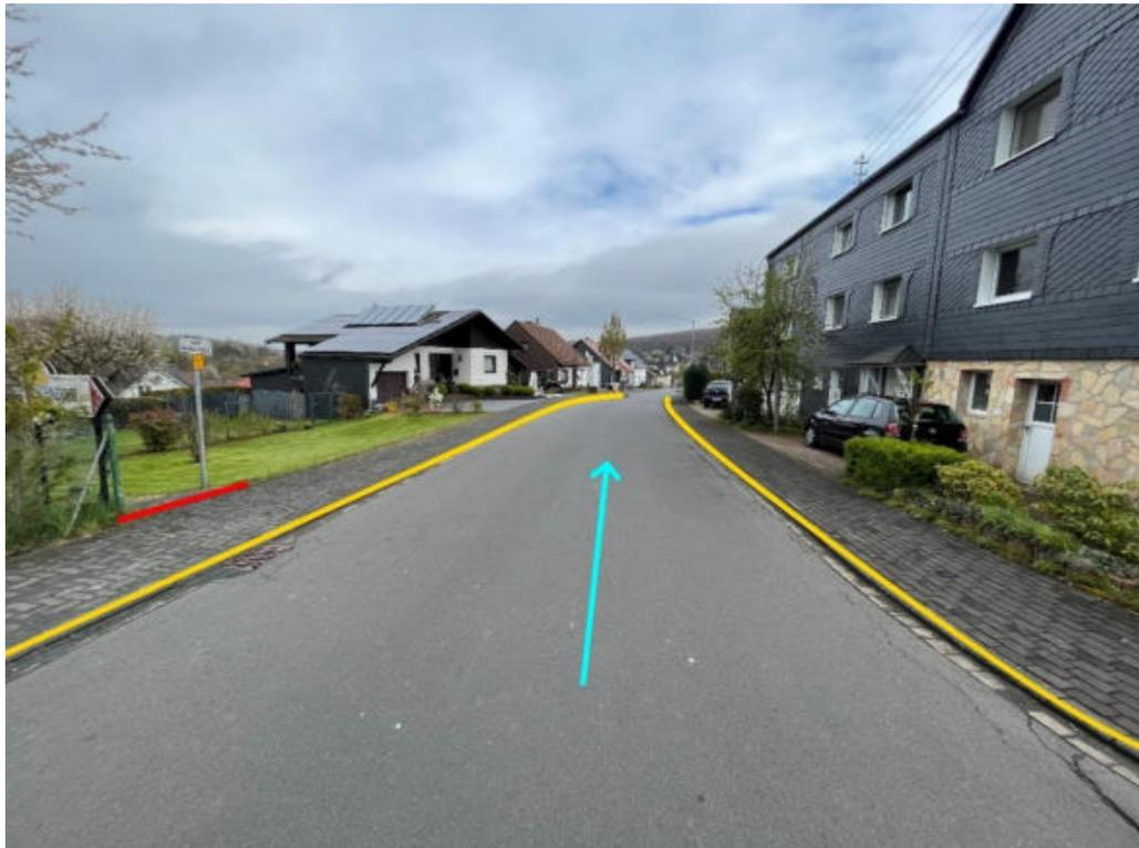
Abbildung 175: Notfließweg „Schwedengrabenstraße“ mit Fließrichtung (hellblau), Hochwasserschutz im Straßenraum (rot) und Bordanlagen (gelb)
