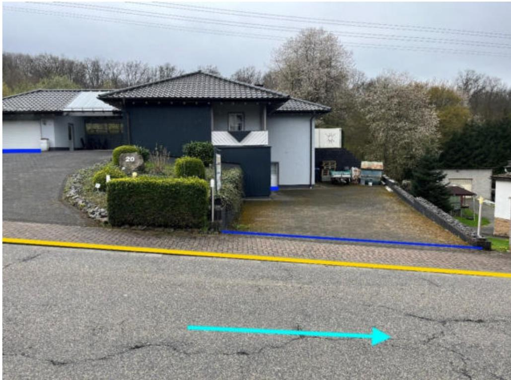
Abbildung 96: Notfließweg „Bindweider Straße“ mit Fließrichtung (hellblau), Objektschutzmaßnahmen (dunkelblau) und Bordanlagen (gelb)
