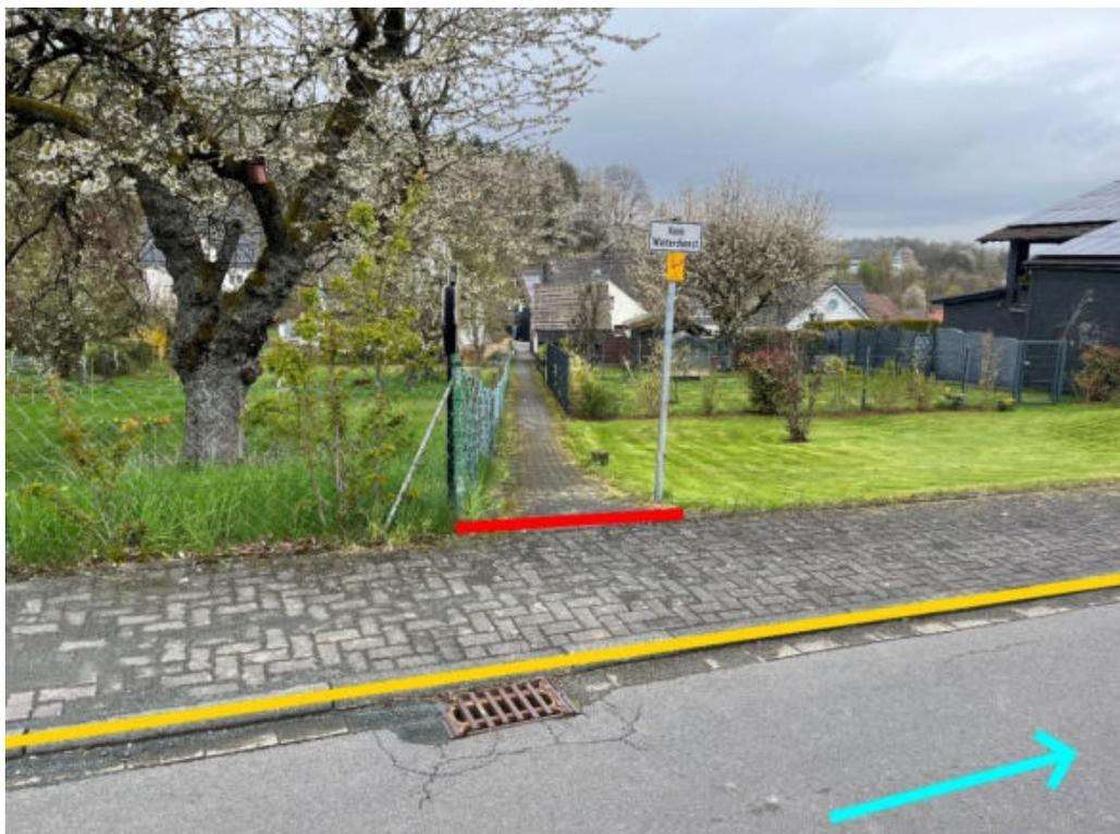
Abbildung 176: Notfließweg „Schwedengrabenstraße“ mit Fließrichtung (hellblau), Hochwasserschutz im Straßenraum (rot) und Bordanlagen (gelb)
