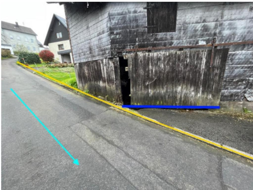
Abbildung 211: Notfließweg „Bergstraße“ mit Fließrichtung (hellblau), Objektschutzmaßnahmen (dunkelblau) und Bordanlagen (gelb)
