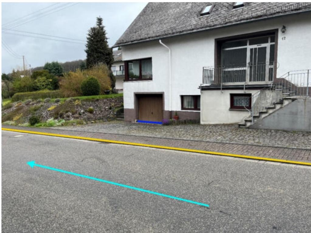
Abbildung 90: Notfließweg „Bindweider Straße“ mit Fließrichtung (hellblau), Objektschutzmaßnahmen (dunkelblau) und Bordanlagen (gelb)
