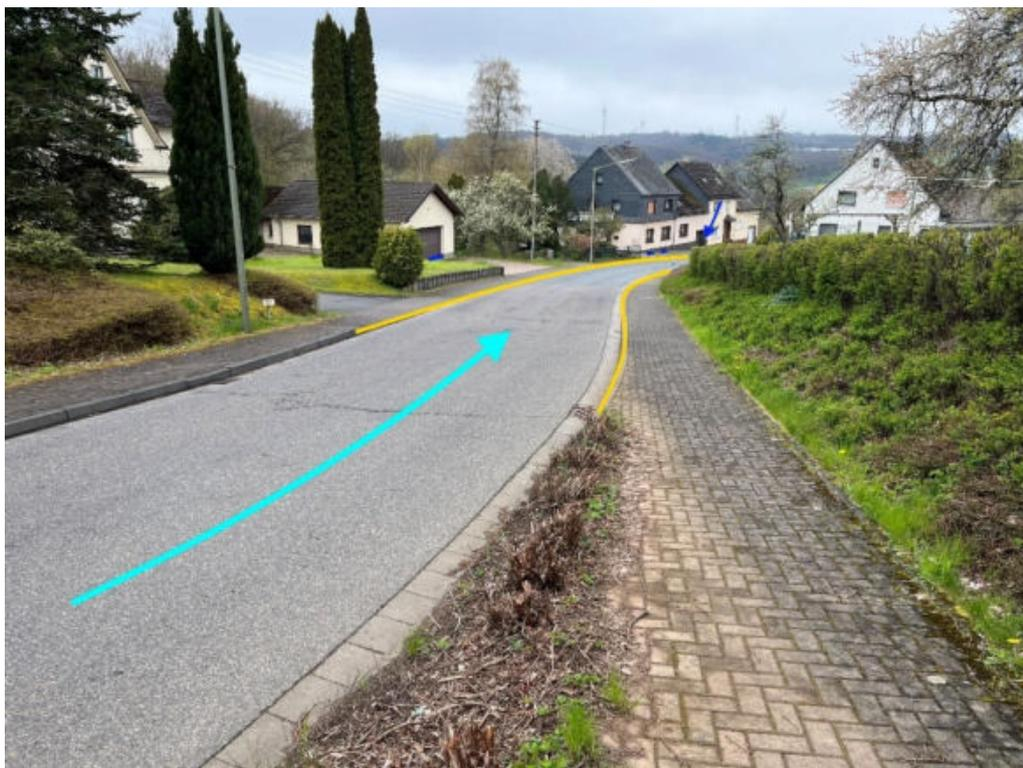
Abbildung 86: Notfließweg „Bindweider Straße“ mit Fließrichtung (hellblau), Objektschutzmaßnahmen (dunkelblau) und Bordanlagen (gelb)
