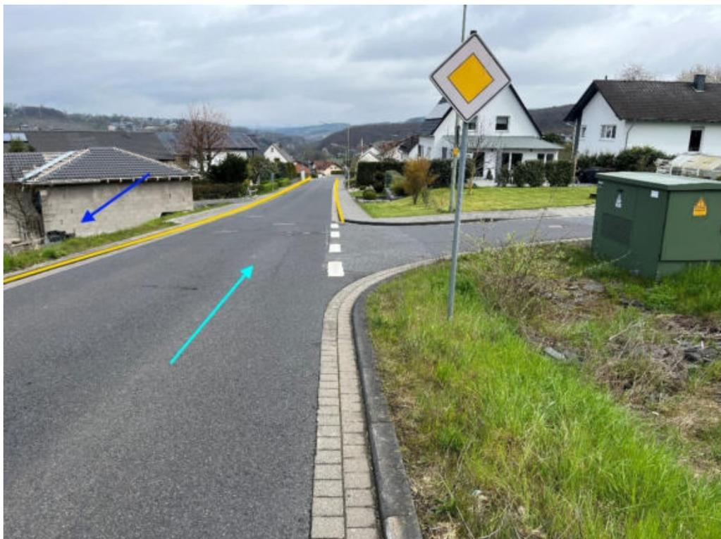
Abbildung 120: Notfließweg „Hahnwallstraße“ mit Fließrichtung (hellblau), Objektschutzmaßnahmen (dunkelblau) und Bordanlagen (gelb)
