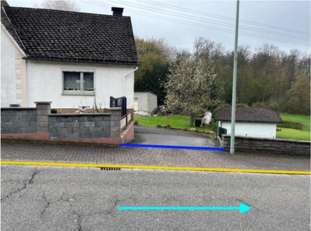
Abbildung 98: Notfließweg „Bindweider Straße“ mit Fließrichtung (hellblau), Objektschutzmaßnahmen (dunkelblau) und Bordanlagen (gelb)
