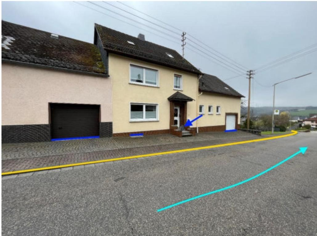
Abbildung 92: Notfließweg „Bindweider Straße“ mit Fließrichtung (hellblau), Objektschutzmaßnahmen (dunkelblau) und Bordanlagen (gelb)
