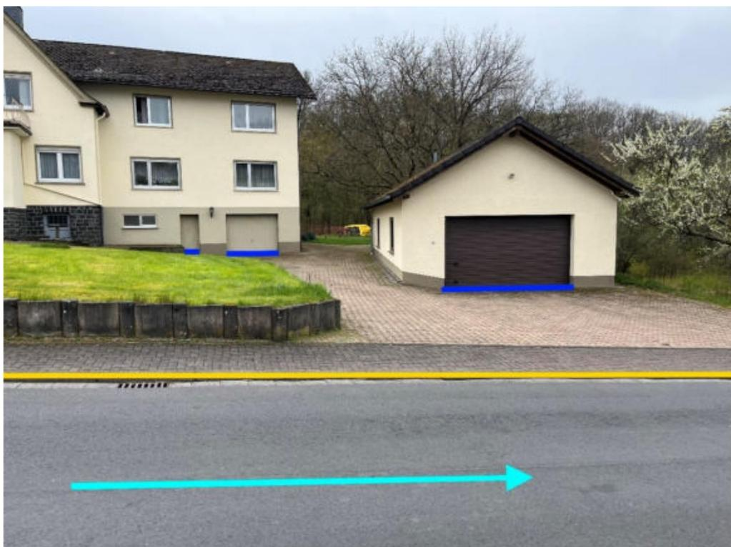
Abbildung 87: Notfließweg „Bindweider Straße“ mit Fließrichtung (hellblau), Objektschutzmaßnahmen (dunkelblau) und Bordanlagen (gelb)
