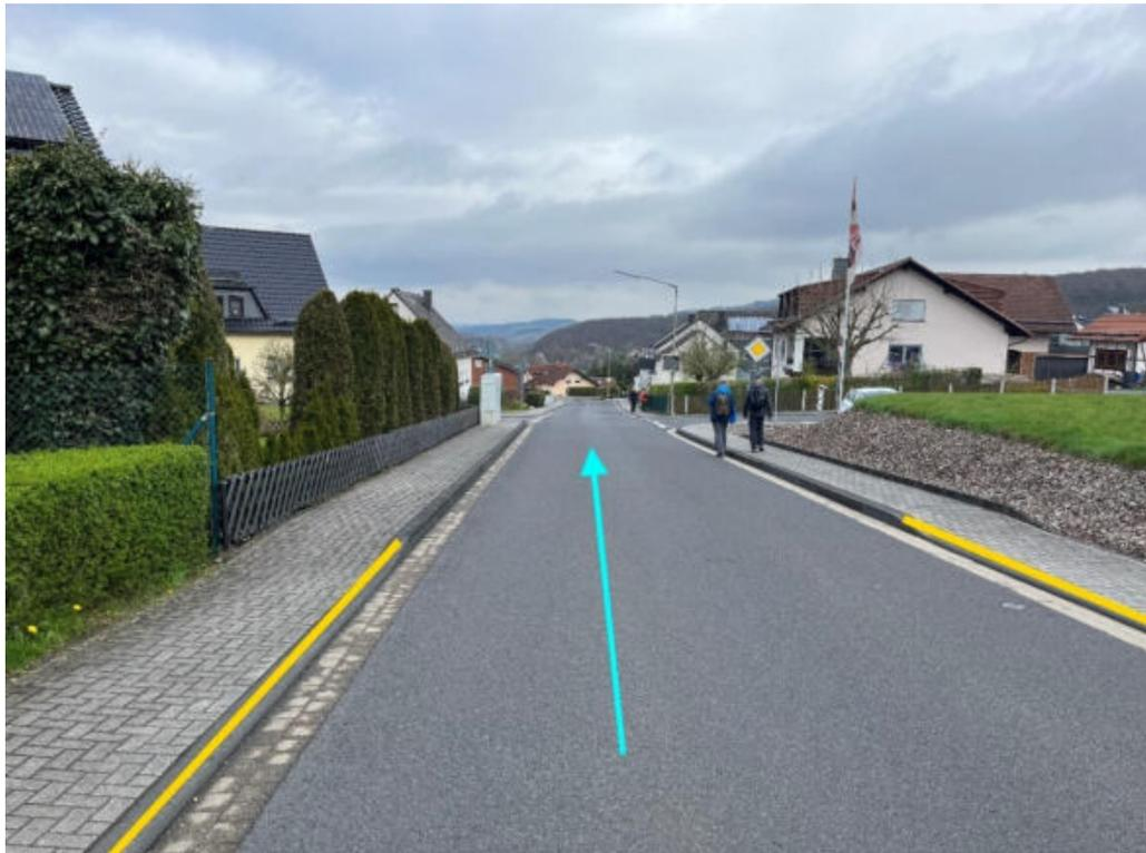
Abbildung 125: Notfließweg „Hahnwallstraße“ mit Fließrichtung (hellblau) und Bordanlagen (gelb)
