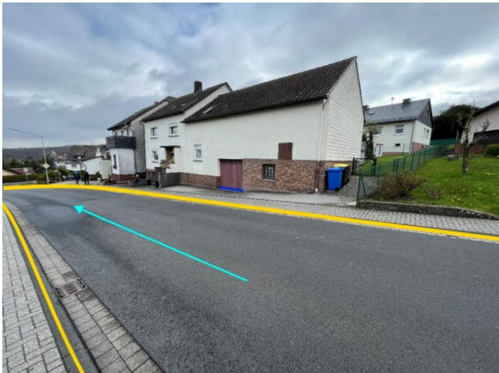
Abbildung 129: Notfließweg „Hahnwallstraße“ mit Fließrichtung (hellblau), Objektschutzmaßnahmen (dunkelblau) und Bordanlagen (gelb)
