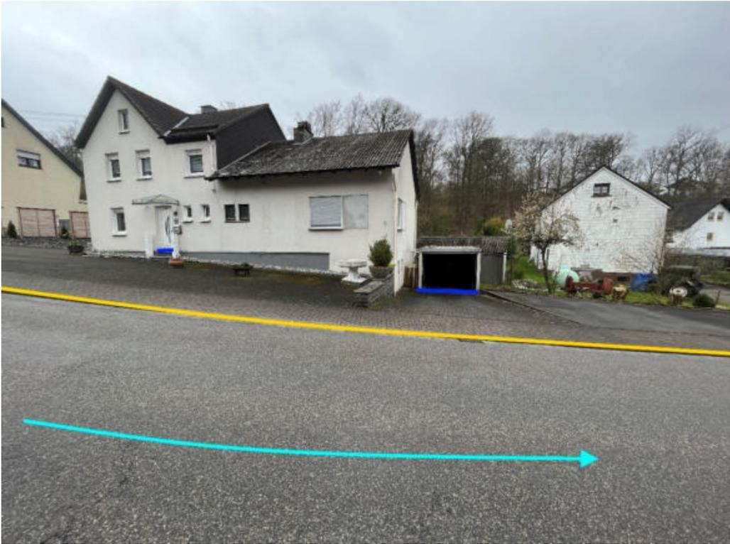
Abbildung 110: Notfließweg „Bindweider Straße“ mit Fließrichtung (hellblau), Objektschutzmaßnahmen (dunkelblau) und Bordanlagen (gelb)
