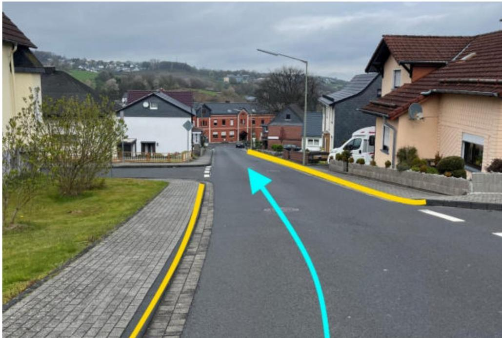
Abbildung 135: Notfließweg „Hahnwallstraße“ mit Fließrichtung (hellblau) und Bordanlagen (gelb)
