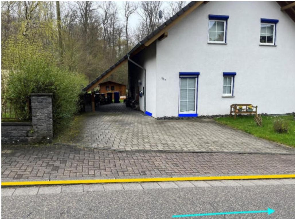
Abbildung 106: Notfließweg „Bindweider Straße“ mit Fließrichtung (hellblau), Objektschutzmaßnahmen (dunkelblau) und Bordanlagen (gelb)
