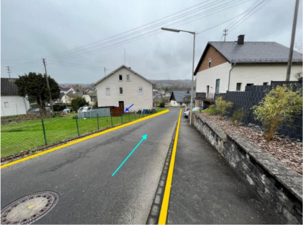
Abbildung 204: Notfließweg „Bergstraße“ mit Fließrichtung (hellblau), Objektschutzmaßnahmen (dunkelblau) und Bordanlagen (gelb)
