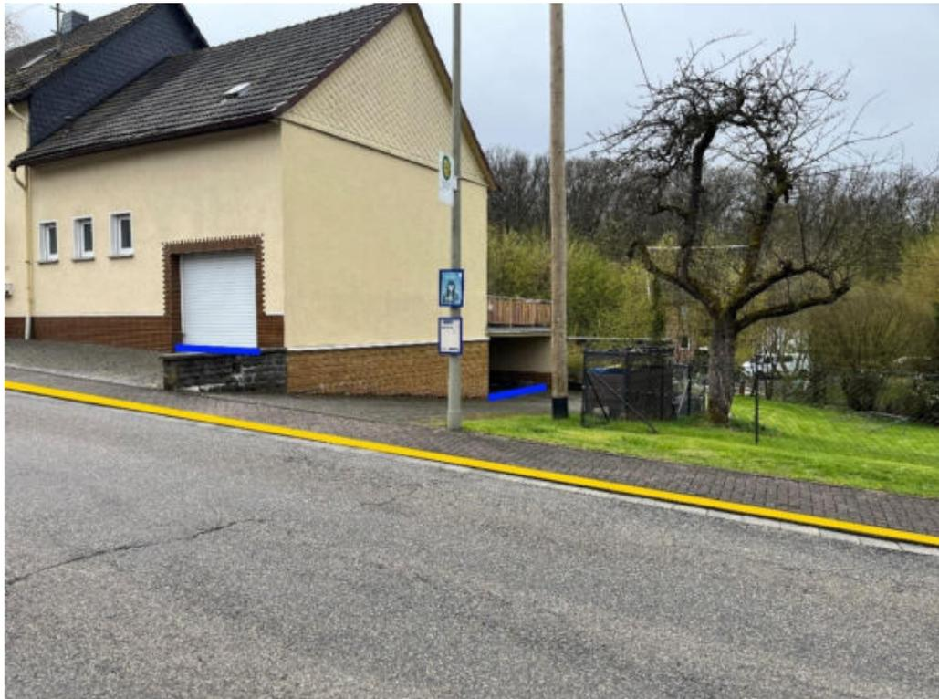
Abbildung 94: Notfließweg „Bindweider Straße“ mit Fließrichtung (hellblau), Objektschutzmaßnahmen (dunkelblau) und Bordanlagen (gelb)
