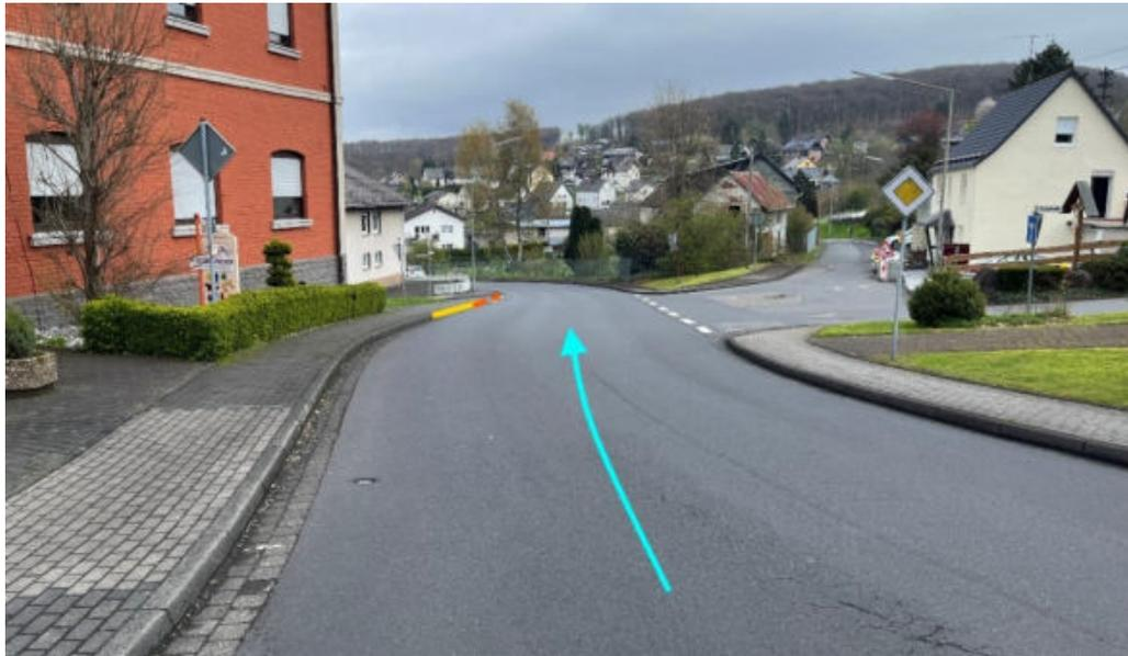
Abbildung 141: Notfließweg „Hauptstraße“ mit Fließrichtung (hellblau), Aufwallung (orange) und Bordanlagen (gelb)
