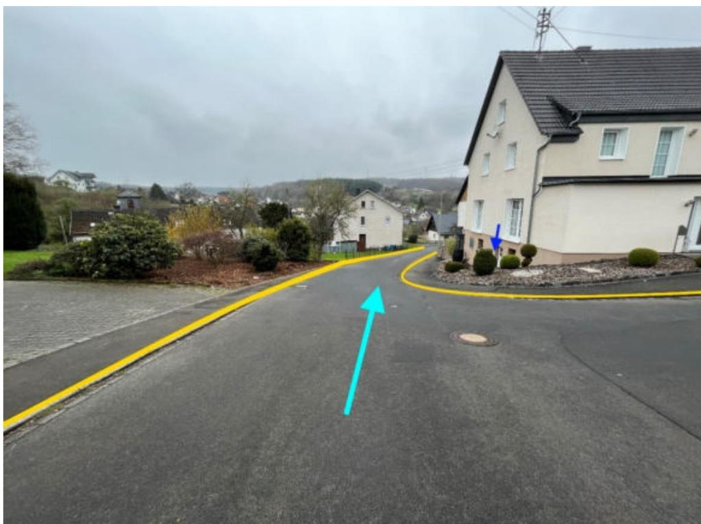
Abbildung 202: Notfließweg „Bergstraße“ mit Fließrichtung (hellblau), Objektschutzmaßnahmen (dunkelblau) und Bordanlagen (gelb)
