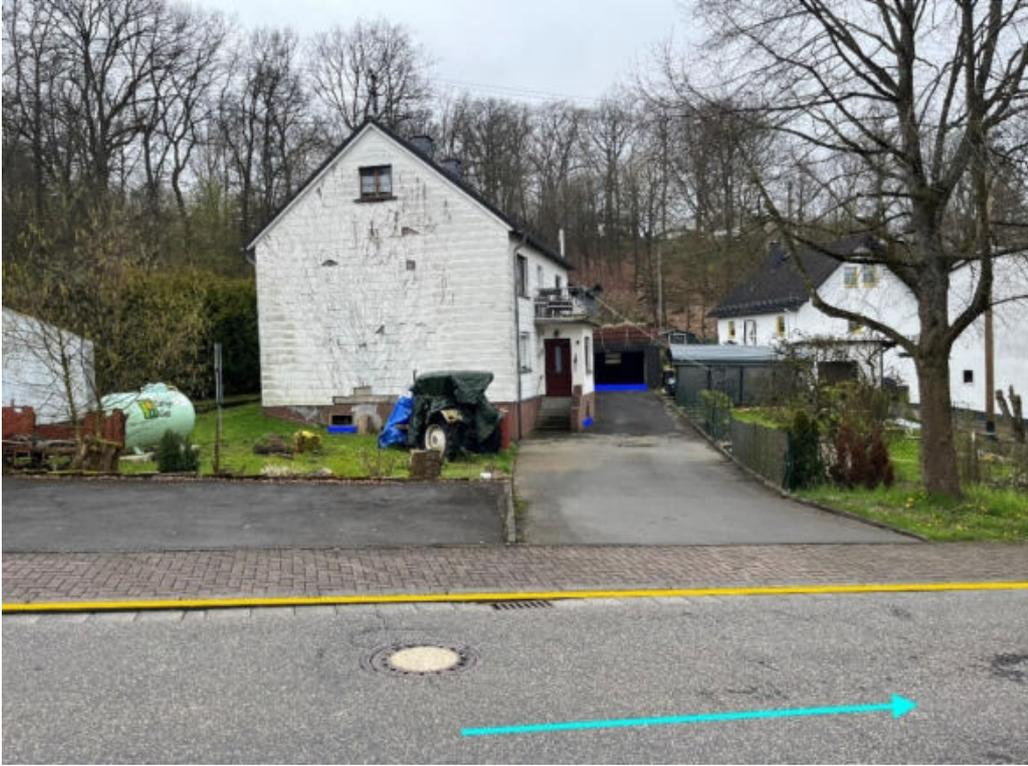
Abbildung 111: Notfließweg „Bindweider Straße“ mit Fließrichtung (hellblau), Objektschutzmaßnahmen (dunkelblau) und Bordanlagen (gelb)
