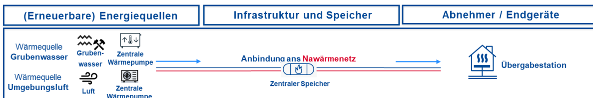
Abbildung 62: Schematische Darstellung des Wärmeversorgungskonzept
