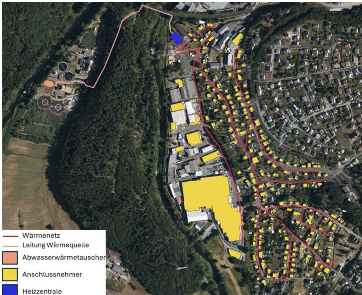
Abbildung 65: Wärmenetz in Scheuerfeld - Einbindung Abwasserwärme
