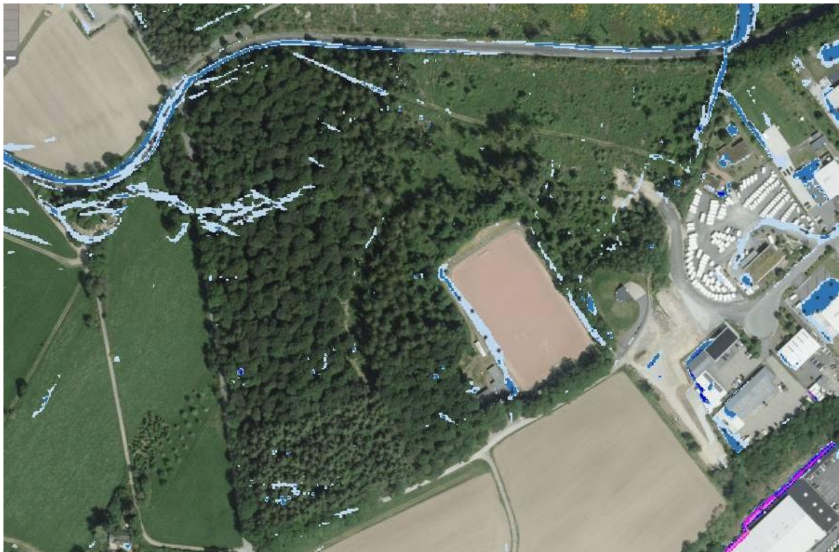
Ausschnitt aus der Sturzflutkarte 15 , außergewöhnliches Starkregenereignis (SRI 7) mit einer Regenmenge von ca. 40 - 47 mm in einer Stunde (entspricht etwa einem 100-jährigen Niederschlagsereignis)
